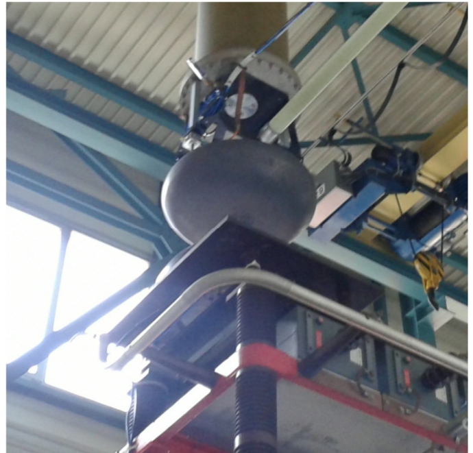
Funkenstrecke im Labor mit hoher Wiederholgenauigkeit (dies ist für die Reproduktion von Versuchsergebnissen notwendig)
