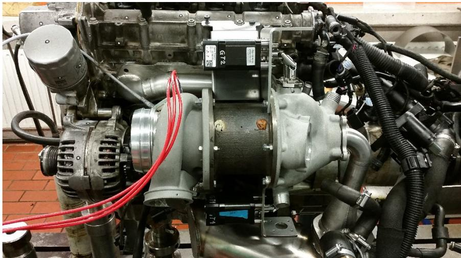
Abbildung 2.1: Aktuelles Bild des Antrova AG Complex Prototyps auf einem Testmotor
